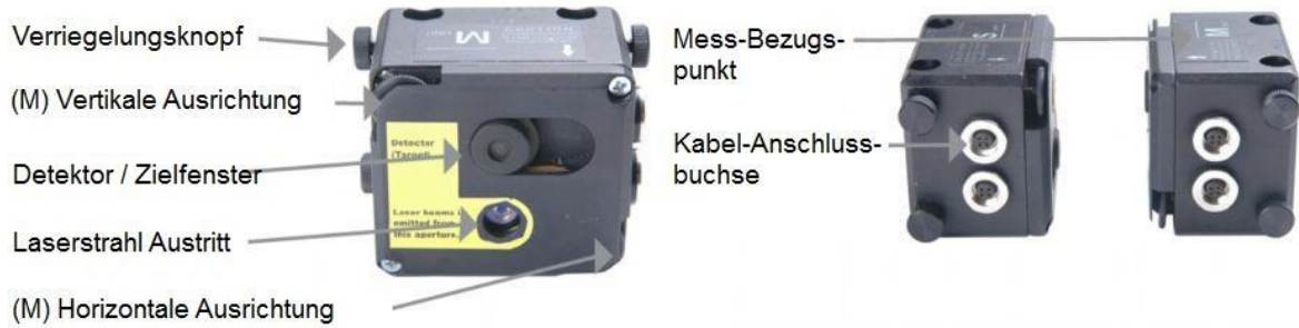
Abb. 1a: Vorder- und Oberansicht Messaufnehmer
